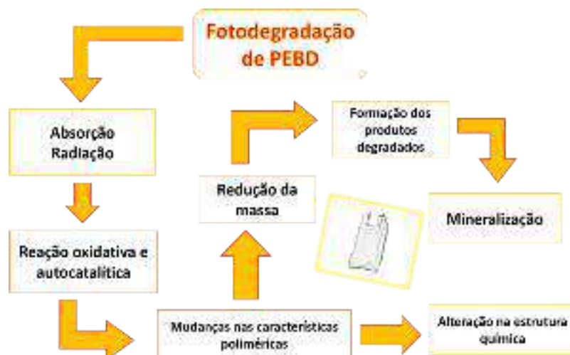
Figura 3: Rotas de reações durante a fotodegradação do polietileno de baixa densidade (PEBD)
