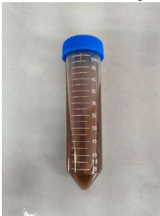
Figura 2 – Nanopartículas de óxido de ferro revestida com alginato
