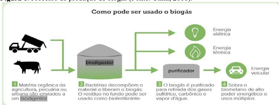
Figura 1. Processo de produção de biogás (Fonte: Unila, 2016).
