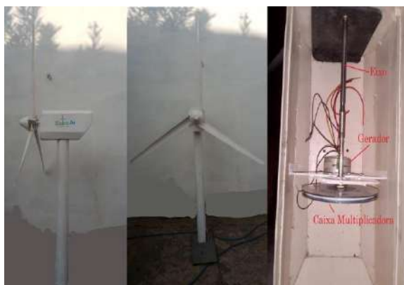
Figura 3 - Aerogerador e estrutura interna.
