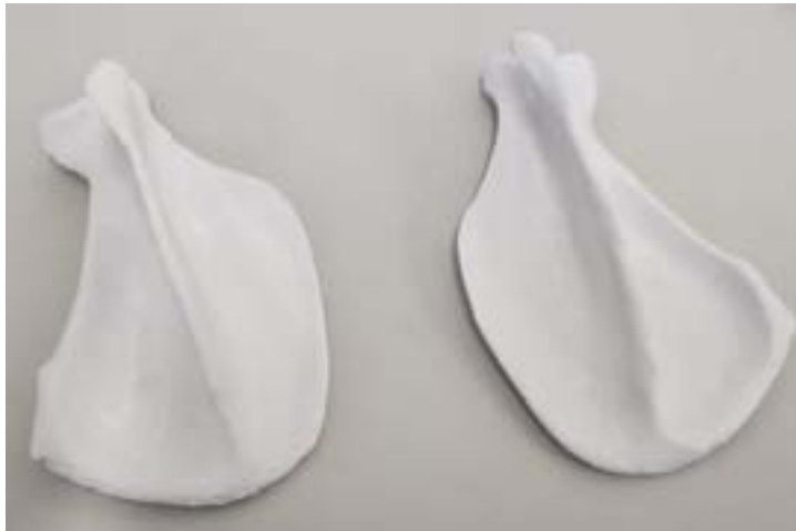
Figura 3. Modelos anatômicos de escápulas direita e escápula esquerda, espécie canina, confeccionadas em PLA mediante impressão 3D.
