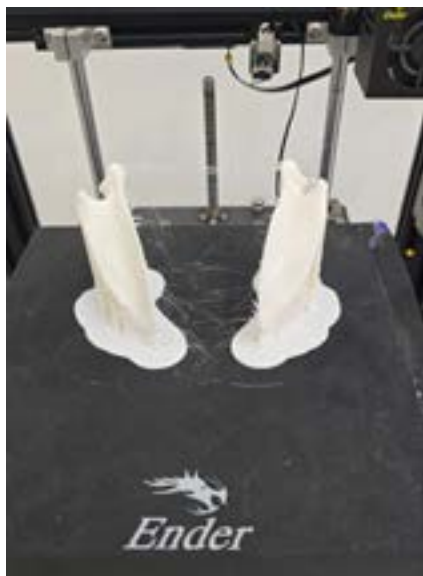
Figura 2. Modelos anatômicos de escápulas direita e escápula esquerda, espécie canina, impressas em PLA através de impressora 3D Ender 5 PRO.
